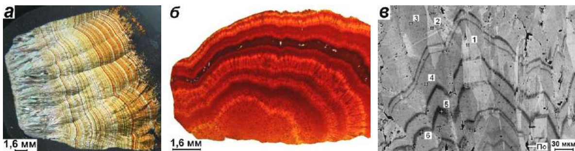
Рисунок 2. Прозрачные шлифы деревянистого олова с полосчатой (а), сферолитовой (б) текстурой, без анализатора. Структура деревянистого олова в ОРЭ. Микрозонд (в). По – поры, 1-6 – номер спектра.
